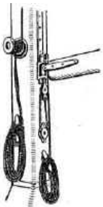
Рис. 41. Передвижной вертлюг гика
