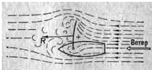
Рис. 2. Действие ветра на паруса яхты, идущей попутным ветром
