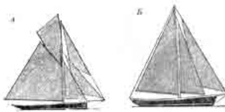
Рис. 14 Тендеры" А — гафельный, Б — бермудский
